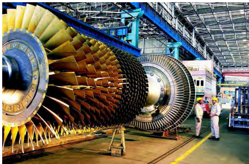
'n Stoomturbine met die buitenste omhulsel verwyder.
