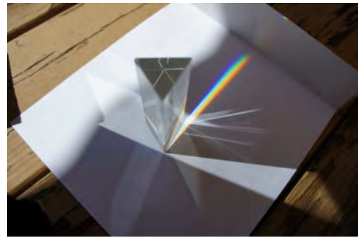
Ligbreking deur 'n driehoekige prisma.
