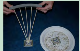
Nou kan jy sien hoe 'n teleskoopspieël baie lig versamel en dit op 'n klein opspoorder, soos jou oog, kan rig.
