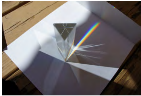
Ligbreking deur 'n driehoekige prisma.
